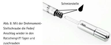
Abb. 8: Mit der Drehmoment-Stellschraube die Feder/Anschlag wieder in den Ratschengriff fügen und zuschrauben
