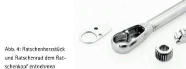
Abb. 4: Ratschenherzstück und Ratschenrad dem Ratschenkopf entnehmen
