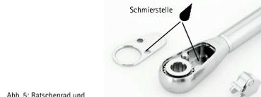
Abb. 5: Ratschenrad und Ratschenherzstück in den Ratschenkopf setzen
